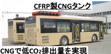
CFRP製CNGタンク
