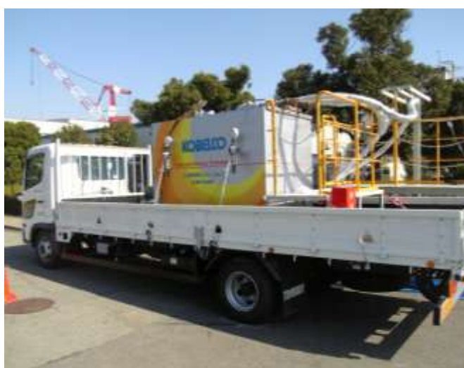
図 1 パイロットスケールの 4 トン蓄熱装置
